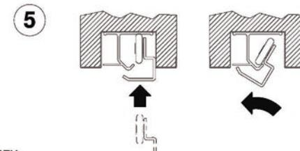
**CZ** Závěsy vložte do drážky vodící kolejnice.
