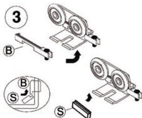
**CZ** Vložte konzolu „B“ do závěsu a upevněte ji pomocí podložky „S“.
