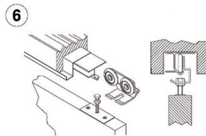
**CZ** Dveře namontujte na závěsy a zkontrolujte posuv.
