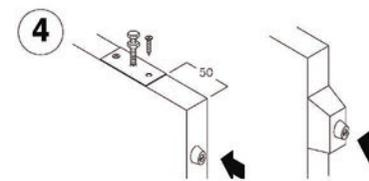
**CZ** Připevněte konzoly na horní hranu a gumové dorazy na zadní hranu dveří. Pokud chcete, aby dveře vyčnívaly z pouzdra, podložte gumové dorazy distanční podložkou.
