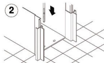
**CZ** Vrtákem Ø 3 mm předvrtáte díry pro upevnění vodícího trnu do podlahy. Upevněte vodící trn k podlaze pomocí přiložených šroubů. Pokud je pouzdro namontované pod úroveň finální podlahy, použijte přiložené distanční podložky. (širší vodící drážku vymezte natočením trnu v ose dveří)
