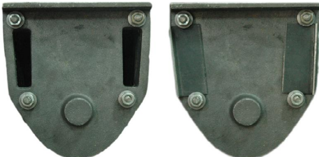
Čelo podávacího systému s čistícími otvory
